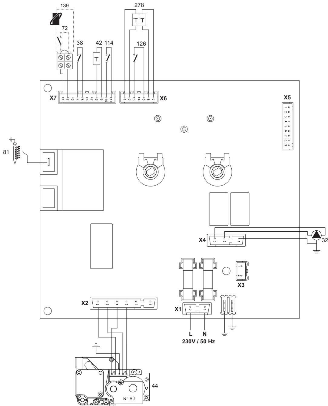
рис. 15 - Электрическая схема
