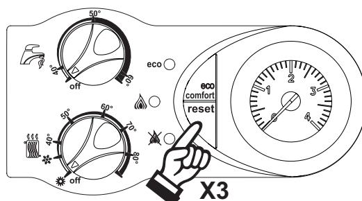
рис. 9 - Режим TEST
