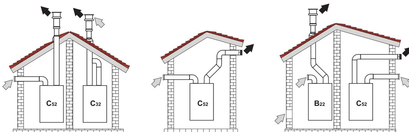
рис. 12 - Примеры подсоединения с помощью отдельных труб (⇨ = Воздух / ⇨ = Продукты сгорания)
