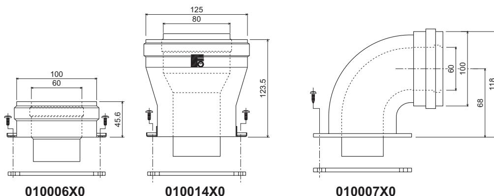
рис. 11 - Исходные элементы для коаксиальных воздуховодов
