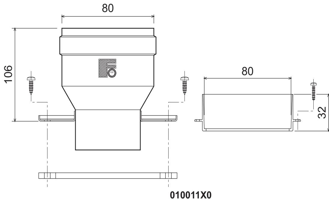
рис. 13 - Исходный элемент для раздельных труб
