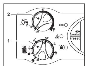
рис. 5 - Режим выработки воды ГВС отключен (только отопление)
