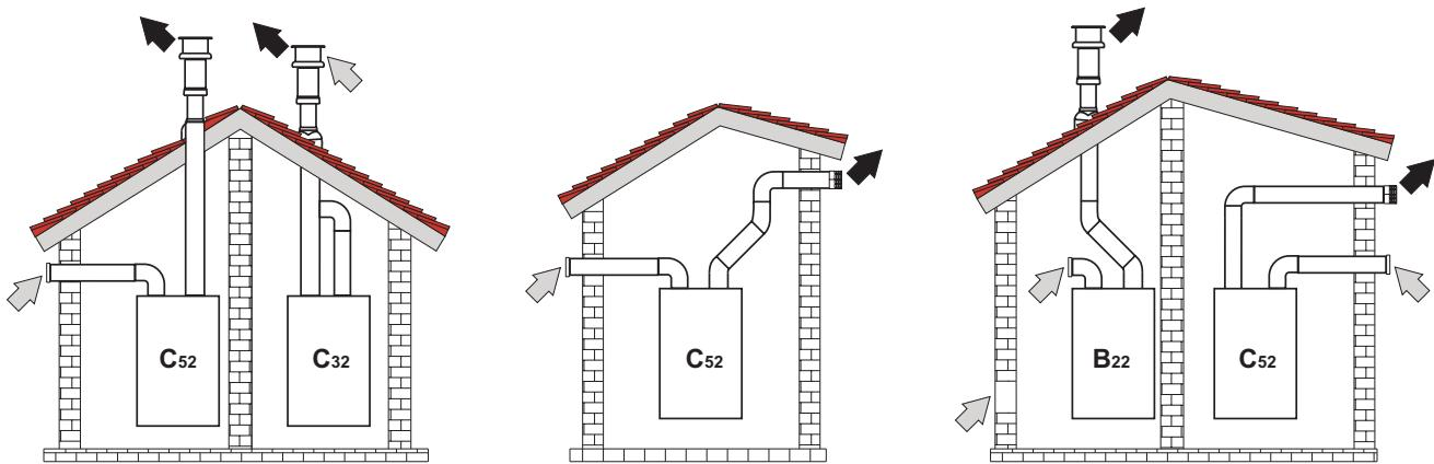
рис. 12 - Примеры подсоединения с помощью раздельных труб (➡ = Воздух / ⚡ = Продукты сгорания)
